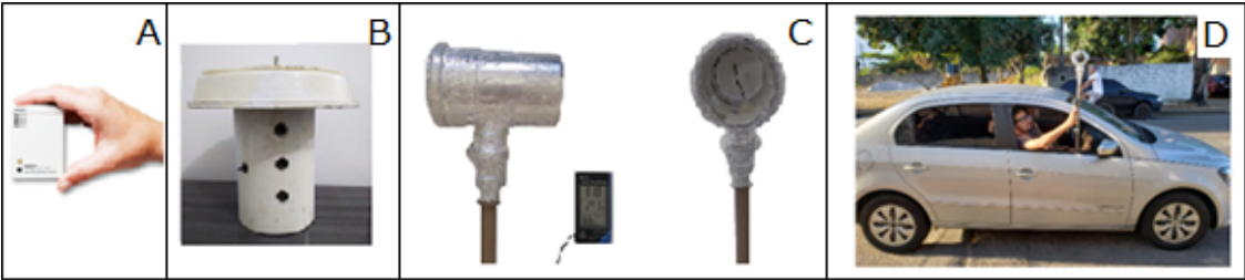
Figura 6 (A) Datalogger modelo Hobo U - 12; (B) Miniabrigo meteorológico; (C-D) Termohigrômetro modelo MINIPA MT - 241 e abrigo de PVC. Organização: Wemerson Diascanio Oliveira, 2020.
