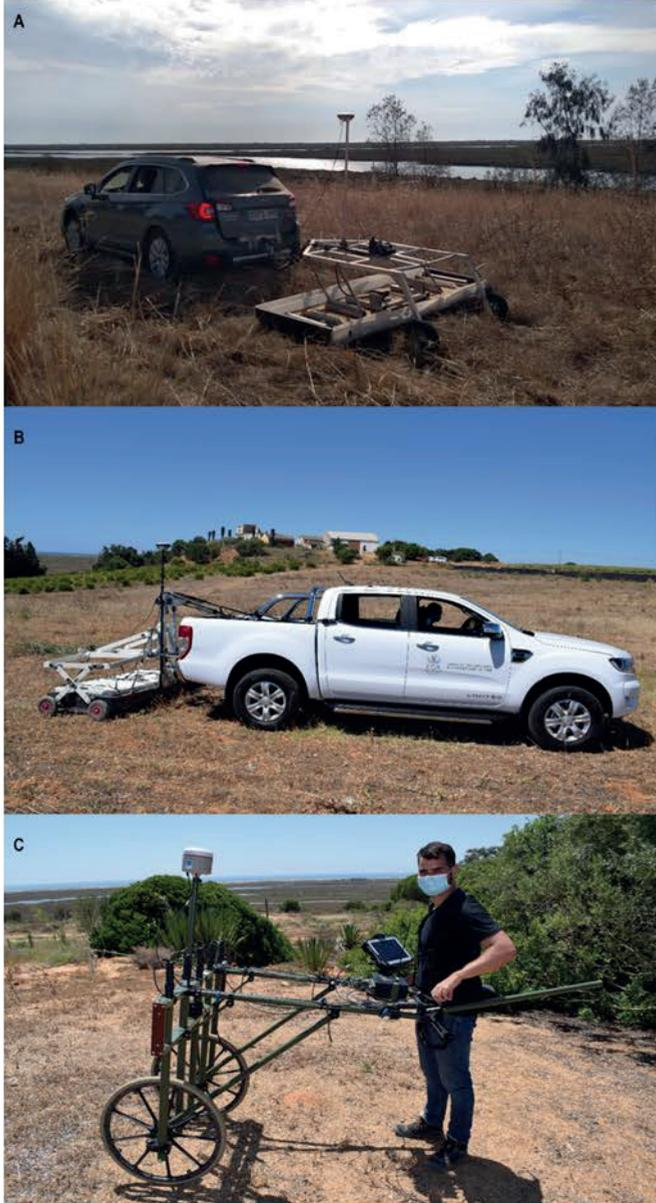
FIG. 1 – A. Georadar Mk-IV 3DRadar; B. Georadar Stream X IDS; C. Magnetómetro MX V3 Sensys.
