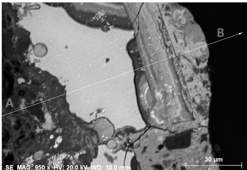
Fig. 7 – Corte estratigráfico do vidro, efectuado com o microscópio eletrónico de varimento na superfície interior, lado 2. A análise estratigráfica foi realizada entre os pontos A e B.
