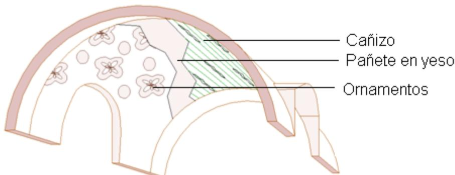
instalaban las piezas y ornamentos de madera que tienen un pin o pata de anclaje que se amarra al extradós de la bóveda.
