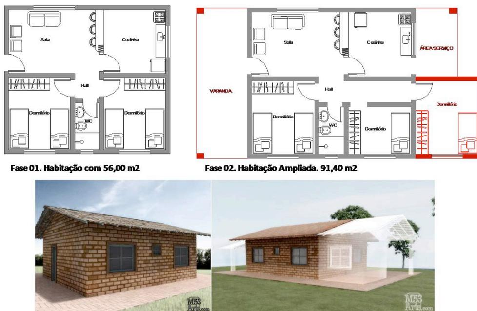
Fig. 2. As duas plantas e perspectivas da Casa de Apoio do projeto CRESCER, respectivamente, sem ampliação e com ampliação. Notar na moradia ampliada os dois dormitórios de dimensões iguais, o contíguo à varanda frontal e o contíguo a varanda de fundo (GEAHAS, 2009)
