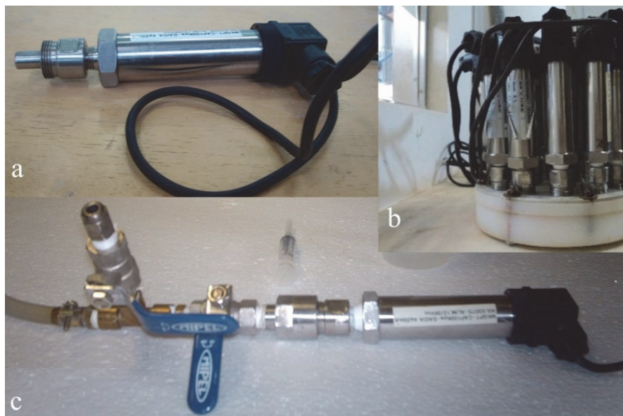
Fig. 3a - Ponta porosa encaixada no corpo do tensiômetro; 3b – Câmara de pressão com os tensiômetros; 3c -Calibração dos tensiômetros (Sousa, 2012).
