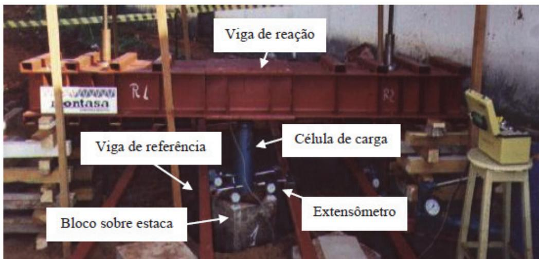
Fig. 7 - Execução da prova de carga no CEEG (Fernal *et al.*, 2003).
