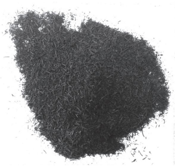
**Fig. 1** - Formato fibrilar do resíduo de borracha de pneus.
