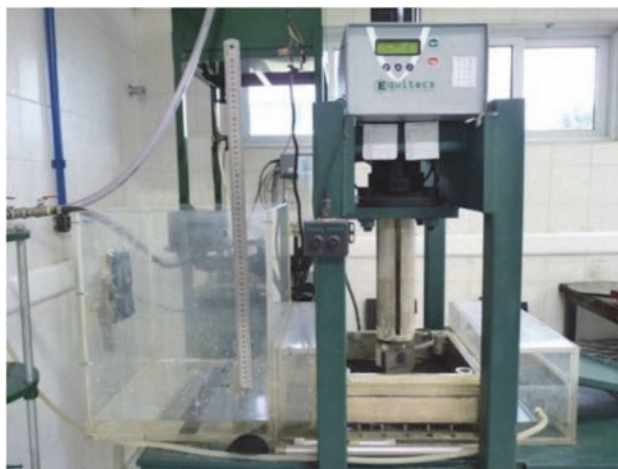
Fig. 3 – Equipamento utilizado no ensaio de transmissividade (Santos, 2017).
