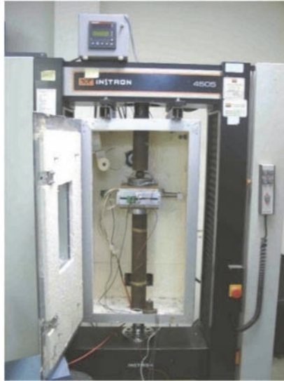
Fig. 4 - Equipamento para ensaio de fluência à compressão - Cortesia TRI Ambiental do Brasil (Santos, 2017).
