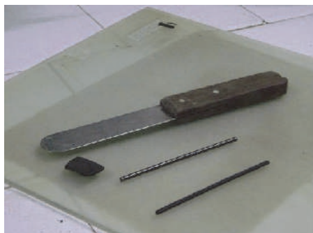
Fig. 15 – Ensaio para determinação do limite de plasticidade.
