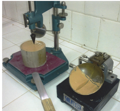
Fig. 14 – Métodos para a determinação do limite de liquidez – cone de queda (à esquerda) e aparelho de Casagrande (à direita).
