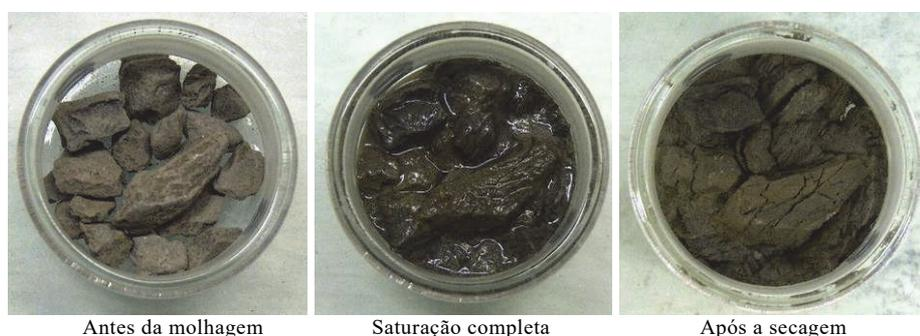
**Fig. 1** – Degradação de fragmentos de marga quando saturados ( $4,75 \text{ mm} < D \leq 9 \text{ mm}$ ).
