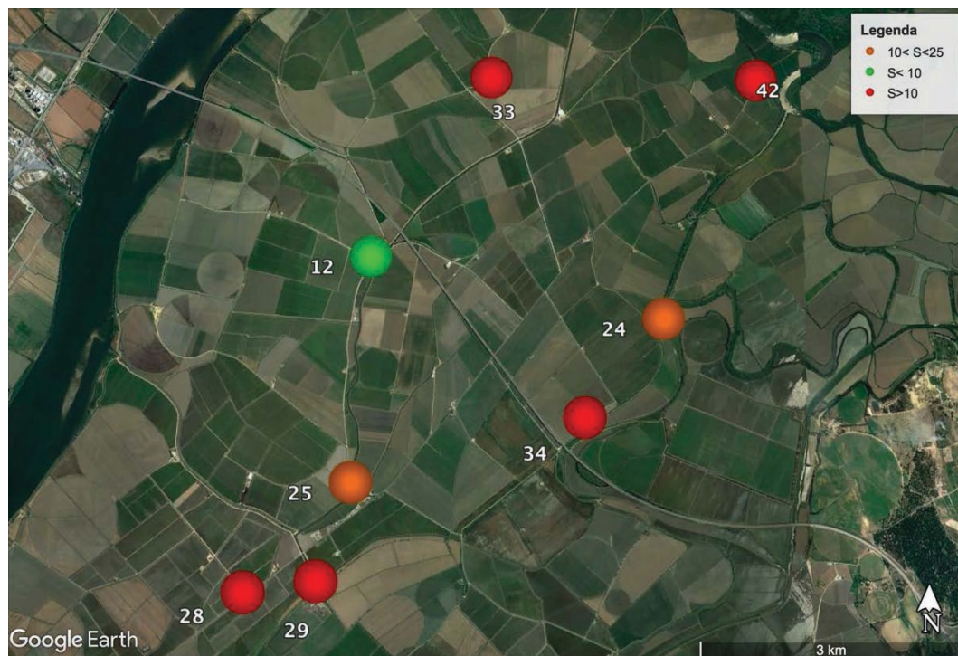
Fig. 18 – Mapa dos assentamentos verticais (S) estimados (valores em cm), segundo Zhang et al. (2002)
