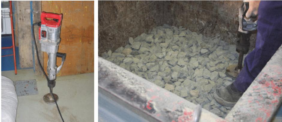
**Fig. 9** – Compactadora manual utilizada en los ensayos.
