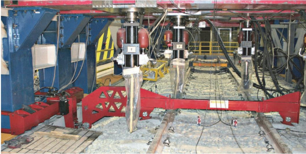
**Fig. 2** – Equipo de tiro de traviesa para la realización de los ensayos, montado sobre una traviesa.
