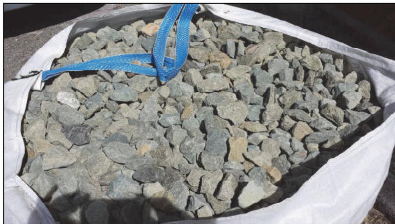
**Fig. 6** – Aspecto del balasto utilizado en los ensayos.
