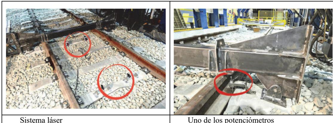
**Fig. 5** – Vista de los elementos del sistema de medición, una vez instalados en la traviesa de ensayo.
