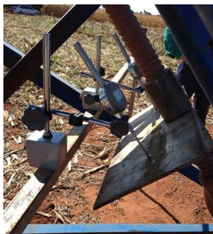
Fig. 6 – Detalhes do equipamento para aferição do deslocamento da estaca
