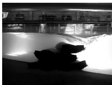
Fig. 32 – Eficiência de vários esquemas proteção: a) modelo A- duna não-reforçada (referência); b) modelos B a D - sistema de reforço dunar; c) Modelo E - estrutura submersa nearshore .
