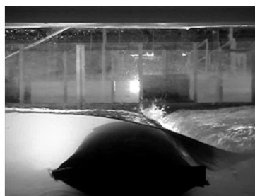
Fig. 32 – Eficiência de vários esquemas proteção: a) modelo A- duna não-reforçada (referência); b) modelos B a D - sistema de reforço dunar; c) Modelo E - estrutura submersa nearshore .
