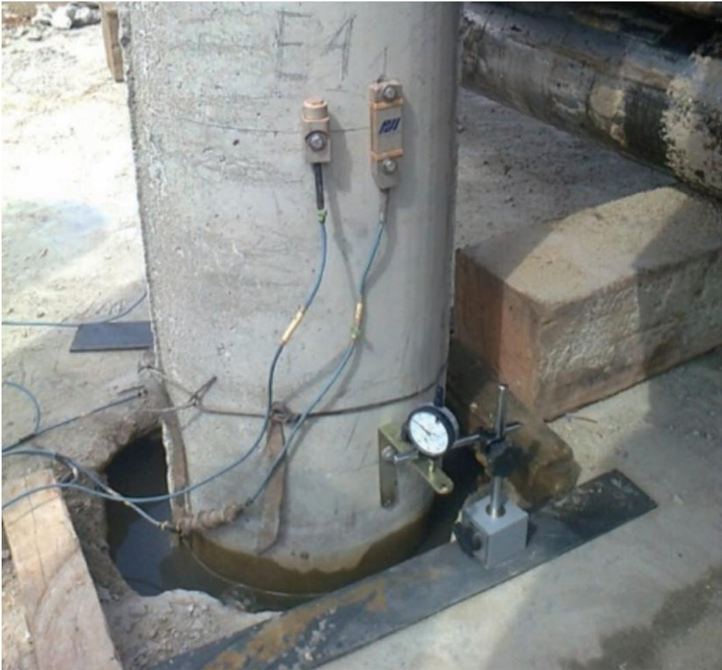
**Fig. 2** – Leitura de recalques com relógio comparador (ampliação da Figura 1, em destaque).
