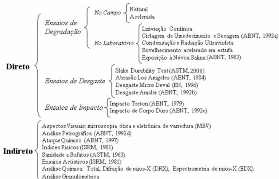
Fig. 1 – Classificação dos ensaios para avaliação da degradação (Salles, 2006).
