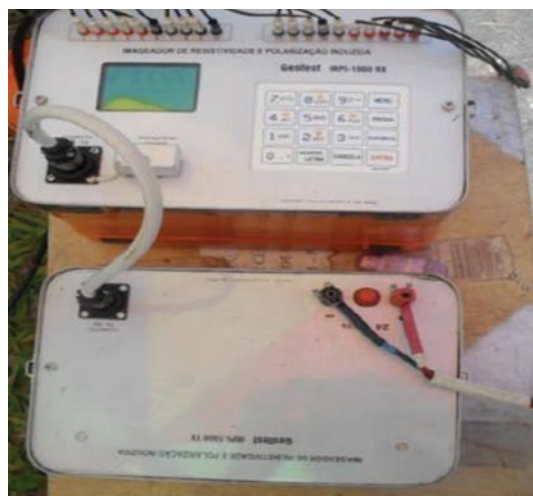
Fig. 4 – Resistivímetro IRPI – 1000 da GEOTEST.
