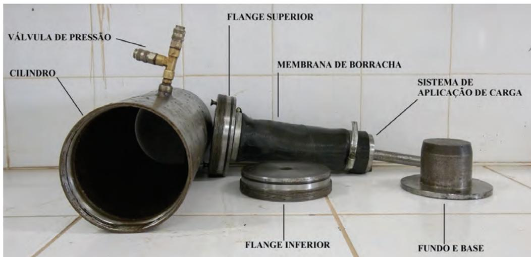
Fig. 2 – Célula triaxial desenvolvida desmontada com a identificação dos componentes.
