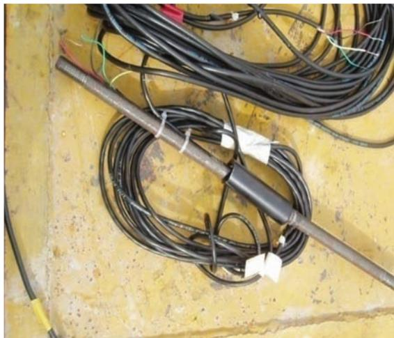
**Fig. 2a** – Barras instrumentadas.
