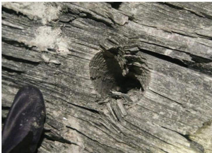
Fig. 4 – Exemplo de quebra dos planos de foliação na parede de um furo de detonação.
