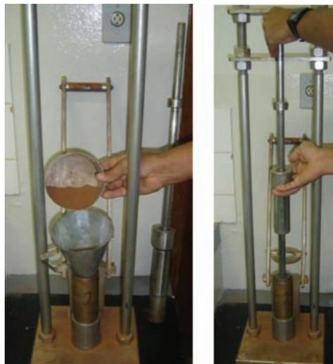
Fig. 3 – Ensaio de compactação Mini Proctor.
