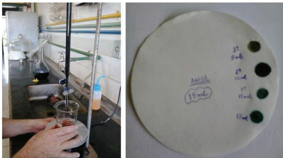
Fig. 4 – Ensaio de adsorção de azul de metileno.
