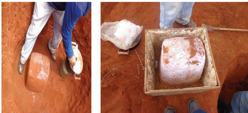
Fig. 2 – Coleta de amostras indeformadas.
