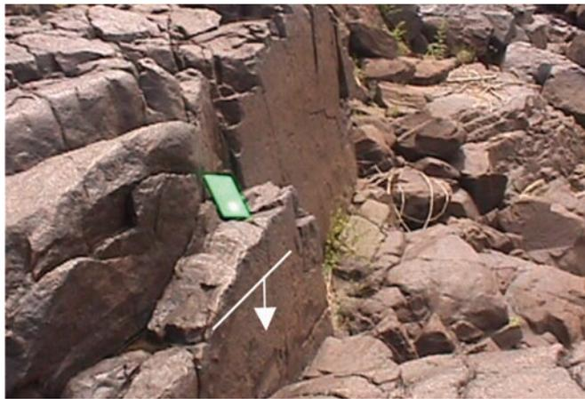
**Fig. 4** – AHE Jirau, jusante da barragem do leito do rio: Descontinuidade da família NW SE, atitude N15° W/82° NE.
