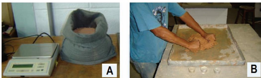
**Fig. 10** – Processo de medição indireta do peso dos sedimentos sólidos: (A) bolsas de geotêxtil com os sedimentos mais grossos coletados em campos; (B) homogeneização da umidade da amostra.
