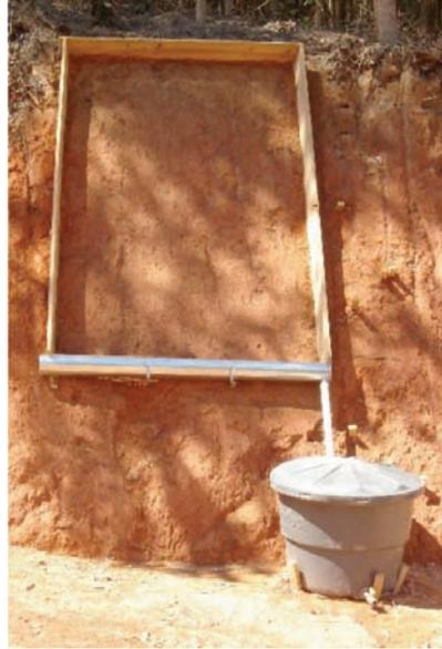
**Fig. 7** – Instrumentação de campo (exemplo de uma célula completa).
