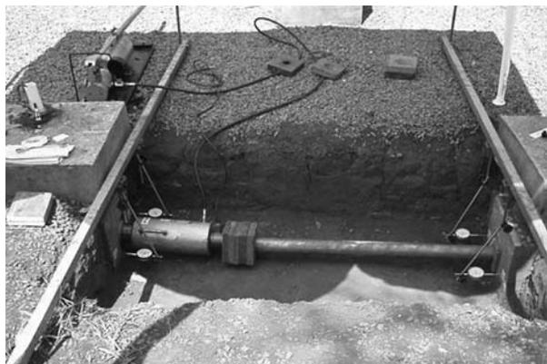
Fig. 4 – Esquema de montagem das provas de carga.
