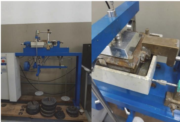
**Fig. 4** – Ensaio de cisalhamento unidirecional, com a amostra 1 do ponto 1 sendo inundada e sofrendo adensamento.
