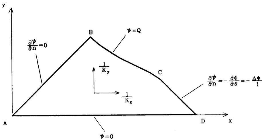
Fig. 4 — Condições de fronteira com a função de corrente  $\psi$  como variável dependente
