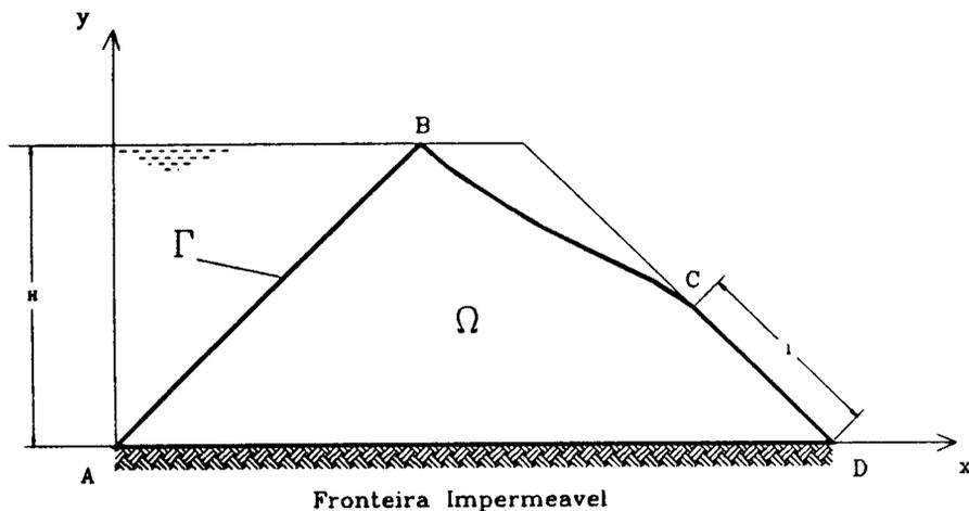
Fig. 1 — Domínio de escoamento e respectiva fronteira de uma barragem de aterro homogénea
