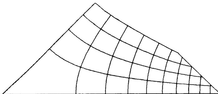
Fig. 5 — Rede de escoamento obtida utilizando o método dos elementos finitos
