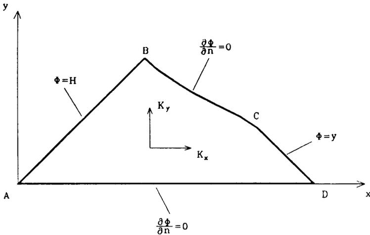
Fig. 3 — Condições de fronteira com a função potencial  $\phi$  como variável dependente
