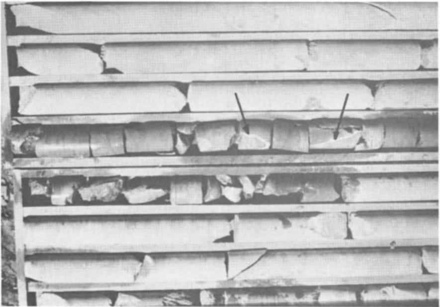
Fig. 20 — Caixa de testemunhos de sondagem ratotiva executada através de terreno cárstico tratado por injeções de cimento e cimento-argila. Os testemunhos claros são de calcário e os escuros de cimento. Note-se o contato íntimo entre o calcário e o cimento, observando-se uma zona de "soldagem" esbranquiçada (flexas).
