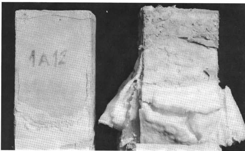
Fig. 6 - Provetes consolidados em ensaio de cristalização de sais. A experimentação laboratorial é indispensável como suporte às tomadas de decisão sobre a aplicação de tratamentos de conservação.
