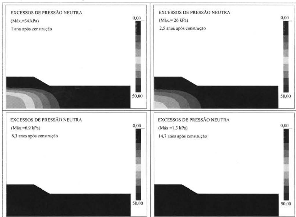
Fig. 6 - Evolução dos excessos de pressão neutra após a construção do aterro.
