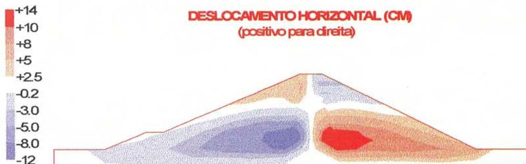
Figura 18 - Isofaixas de deslocamento horizontal no final da construção.
