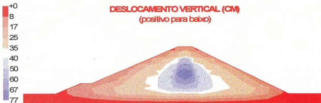
Figura 17 - Isofaixas de deslocamentos verticais no final da construção.
