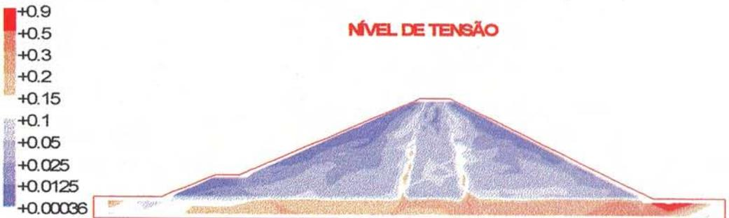
Figura 16 - Distribuição do nível de tensão no final da construção
