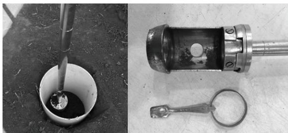
**Fig. 5** – Equipamento utilizado para coleta das amostras indeformadas de solo.
