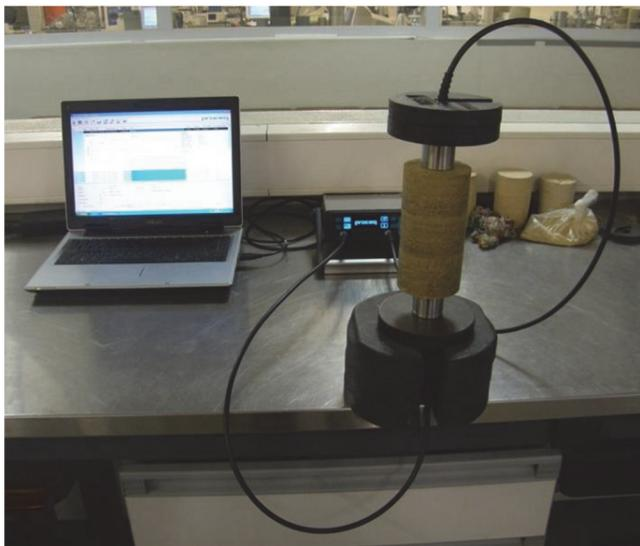
**Fig. 3** – Fotografia do equipamento usado para medição da velocidade de propagação das ondas sísmicas (Panico, 2018)
