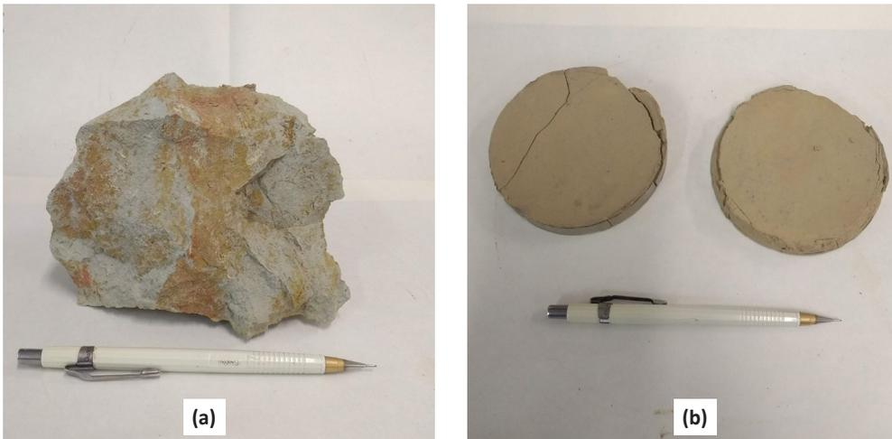
Fig. 7 – Características visuais do Taguá (a) Amostra do Taguá indeformado (b) Amostras do Taguá reconstituído.
