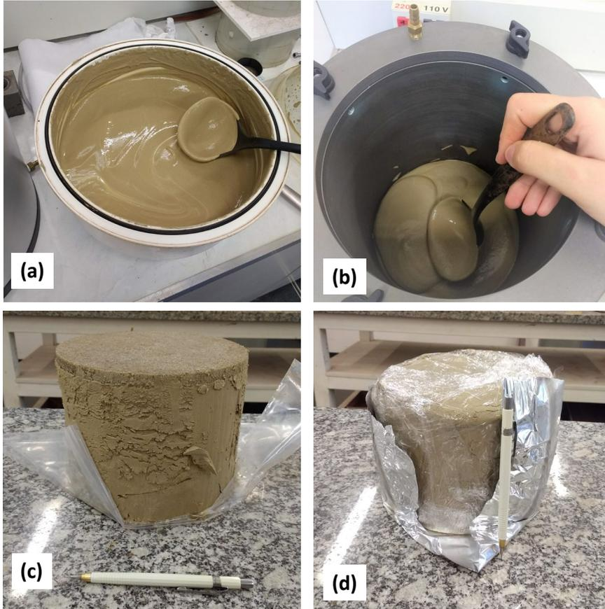
**Fig. 3** - Preparação da amostra reconstituída (a) deaeração feita no dessecador (b) Colocação do material na célula e adensamento (c) Amostra após processo de adensamento sob tensão vertical de 100 kPa. (d) Amostra sendo embalada para proteção.
