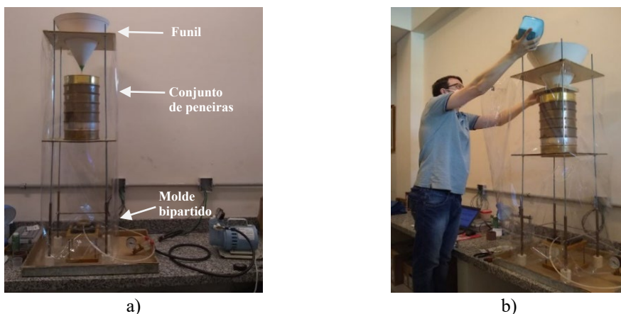
Fig. 6 – (a) Aparato para moldagem dos corpos de prova médios, compactos e muito compactos; (b) Deposição da areia para iniciar a pluviação.
