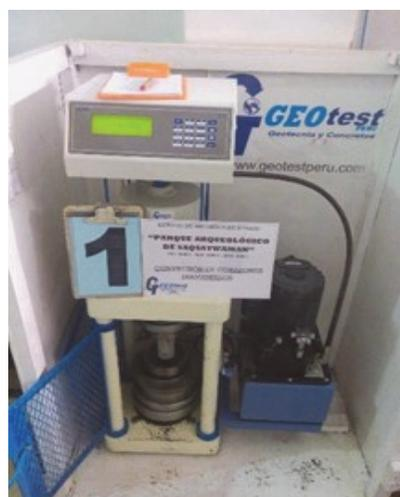
(b) Ensayo de Compresión
