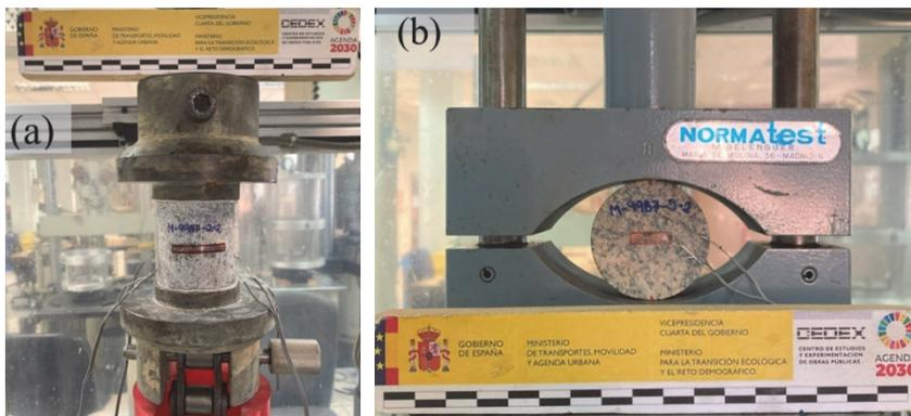
**Fig. 16** – Provetes de granito do Porto. (a) RTD; (b) BT
