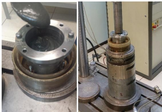
Fig. 18 – (Izquierda) Vertido de la mezcla de material y agua en el molde edométrico recrecido. (Derecha) Consolidación estática en una prensa independiente al equipo de corte.
