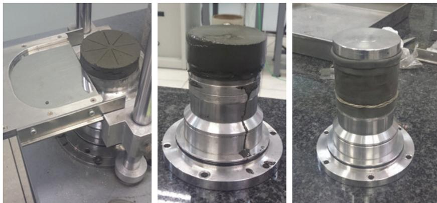
**Fig. 19** – Proceso de tallado de la probeta resultante tras la consolidación, e instalación dentro de la membrana impermeable sobre el pedestal para su montaje en el equipo de corte.
