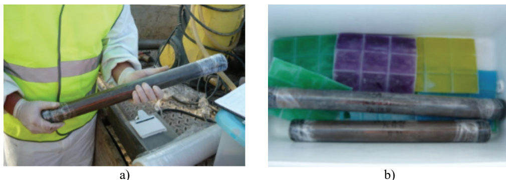
Fig. 10 – a) Porta-amostra selado; b) acondicionamento dos porta-amostras na arca térmica.
