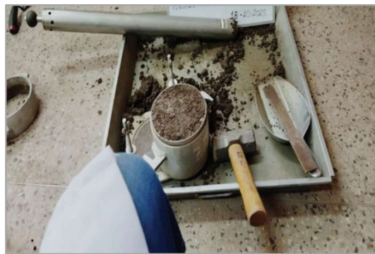
Fig. 3 – Superficie enrasada y escarificada, retirando el material excedente del molde, para obtener una lectura precisa del espécimen compactado.
