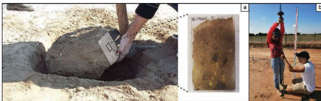
Fig. 8 – a) Cateo de probeta del 2° tramo a la edad de 155 días para realizar corte delgado; b) Ensayo de penetración liviana (DCP ligera).
