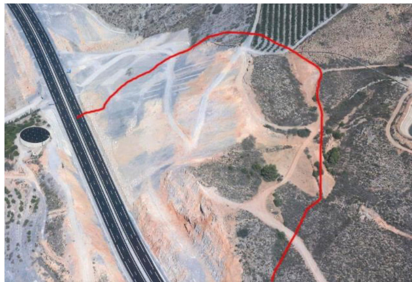
Fig. 15 – Vista del área afectada por el deslizamiento. La línea roja representa el contorno de la zona movilizada.
