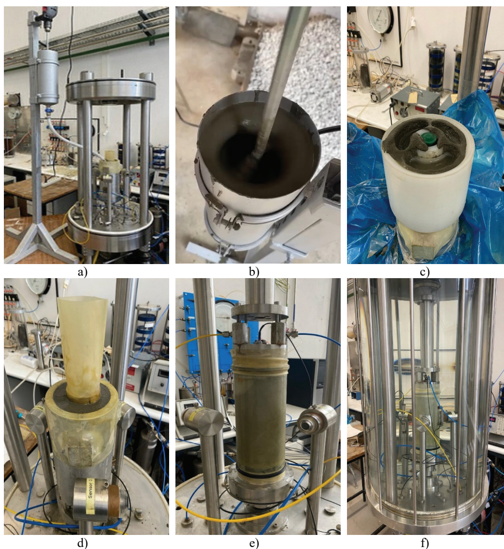
Fig. 6 – Sequência de montagem de amostras de rejeitados da mineração no HCA.: a) agitador mecânico; b) mistura dos rejeitados na cuba metálica; c) alongo após a deposição da pasta; d) amostra após assentamento; e) amostra com sucção; f) amostra com a instrumentação local instalada dentro da campânula.
