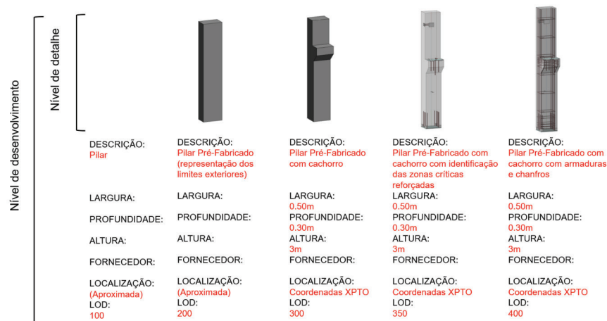
Fig. 9 – Exemplo de diferentes níveis de desenvolvimento e detalhe no modelo BIM (adaptado de Mcphee (2013) e de BIM Forum (2024)).
