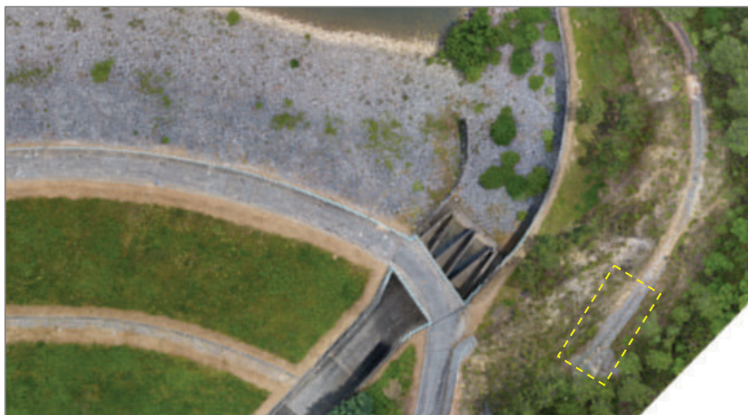
Fig. 36 – Localização da zona onde ocorrem fissuras na caleira do talude de escavação junto ao descarregador.
