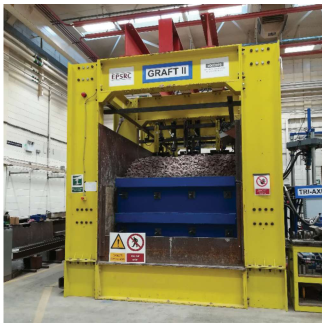
Fig. 6 – Equipamento GRAFT-2 (a ensaiar uma via balastrada).
