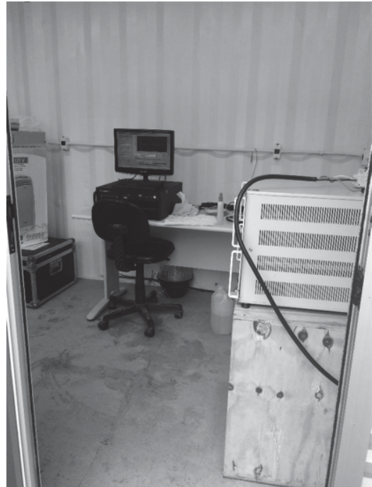
Fig. 7 –DTS e fonte de aquecimento.
