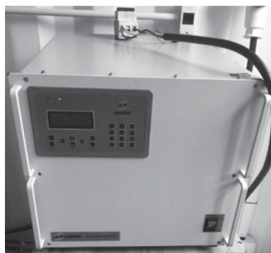
Fig. 8 – Fonte de aquecimento FCC-900-30-i.
