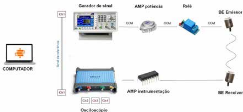
Fig. 14 – Visão geral do sistema de monitorização adaptada (Briceño et al.2026).
