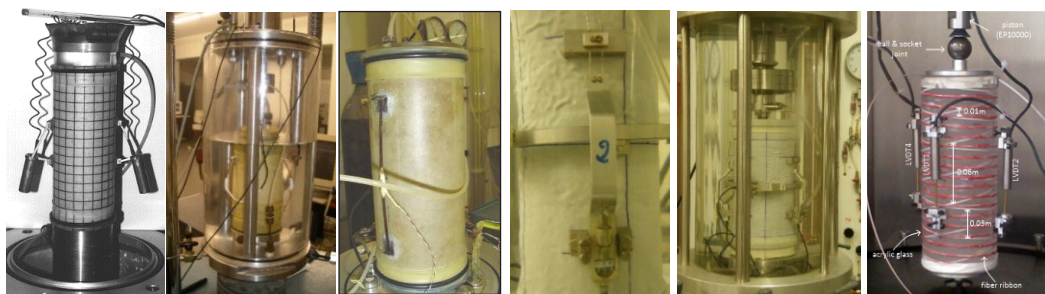
Fig. 2 – Instrumentação para medição direta de deformações em câmaras triaxiais.
