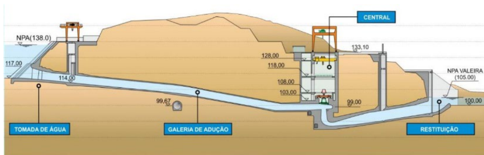
Fig. 26 – Circuito hidráulico e central do Feiticeiro. Perfil longitudinal.
