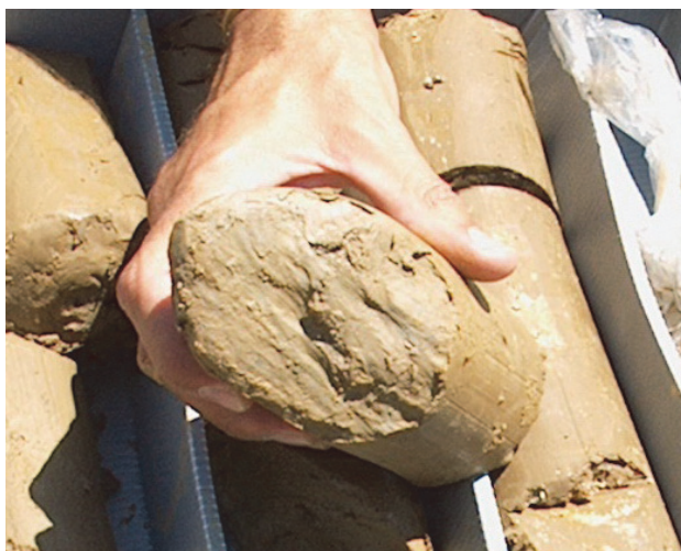
Fig. 30 – Superficies de cizalla en las arcillas rígidas de alta plasticidad de Viadesens, Gerona (Autopista AP-7).
