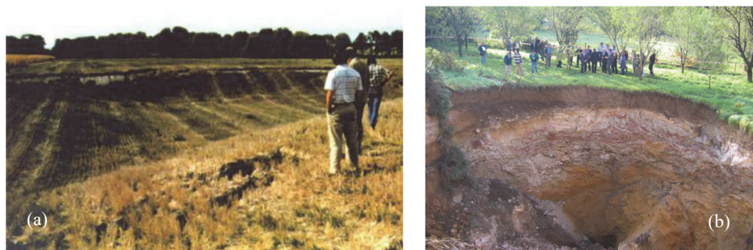
Fig. 5 – Roturas após o encerramento de minas: (a) subsidência controlada por descontinuidades; (b) rotura em chaminé numa mina de gesso (Didier et al., 2008).
