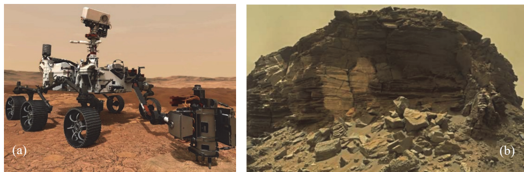
Fig. 9 – Mecânica das rochas extraterrestres: (a) sonda para furação do robô Preservance em Marte (ABC, 2021); (b) rotura de um talude em Marte (Aydan, 2017)
