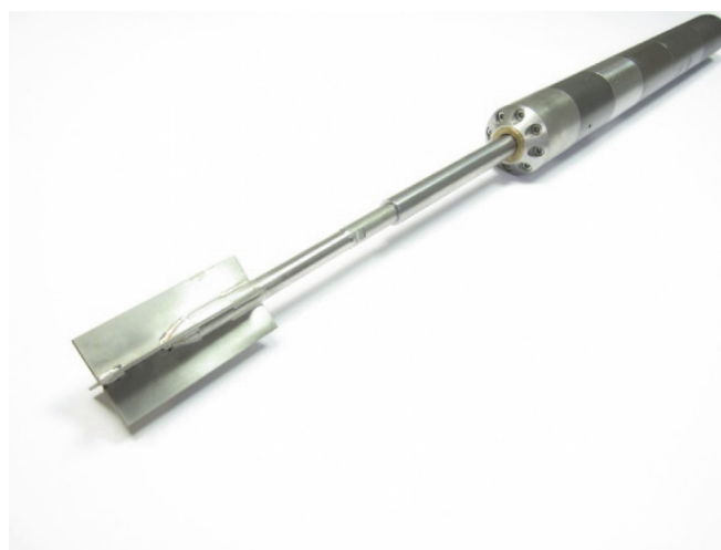
Fig. 17 – Equipamentos de vane atuando com motor servo-controlado permitindo distintas velocidades de rotação da palheta (Cortesia A. P. van den Berg)
