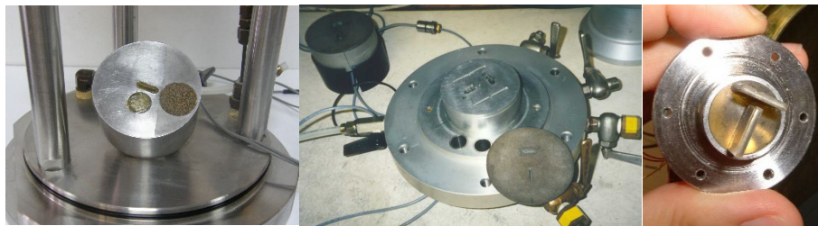
Fig. 7 – Transdutores piezocerâmcos, ondas S e P: (a) bender elements (BE) e compression plates (ISMES); (b) bender-extender elements, BEE (UoB); (c) BE em T, hv e hh (UWA).
