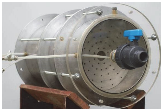
Fig. 29 – Célula de ensaio do LNEC usada no ensaio de erosão para avaliação da capacidade de limitação da progressão da erosão interna nas fendas (Correia dos Santos, 2014).
