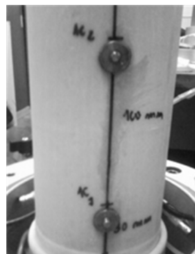
Fig. 20 – Ensaio de coluna ressonante não convencional (Camacho-Tauta et al., 2010a).
