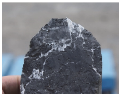
Fig. 3 – Superficie cizallada en la pizarra arcillosa de facies Keuper. Túnel de Albertia.
