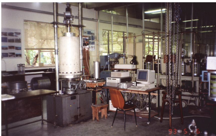
Fig. 13 – Ensaio triaxial de grande dimensão, em que é possível impor uma trajetória de deformação
