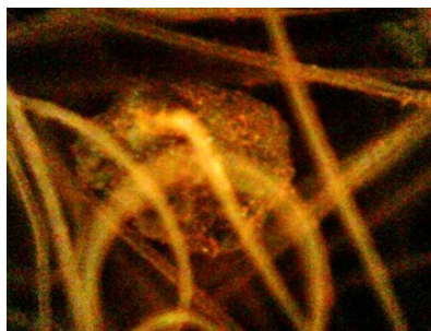
(b) Grão dentro do geotêxtil.
