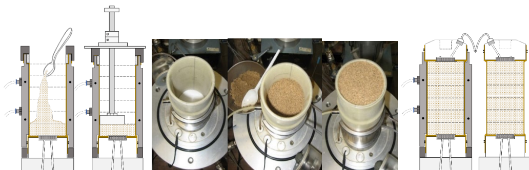
Fig. 4 – Fases de montagem: a) ajuste da membrana ao molde; b) introdução de uma camada de areia; c) fase final da colocação da areia no molde (adapt. de Viana da Fonseca et al. 2021).
