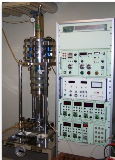
Fig. 14 – Equipamento de coluna ressonante no Laboratório de Geotecnia do IST.
