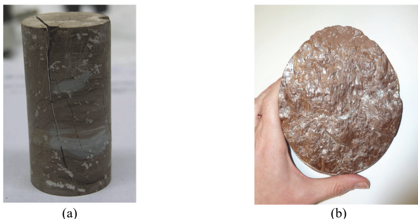
Fig. 2 – (a) Testigo de la argilita de Lilla; (b) Superficie estriada extraída de Lilla.
