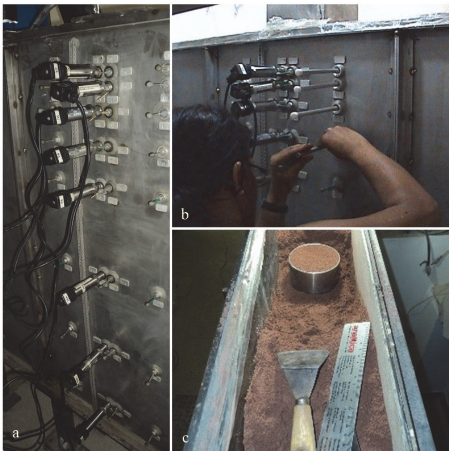
Fig. 5a - Fundo do canal de fluxo com tensiômetros instalados; 5b - Amostragem após ensaio para determinação da umidade nos pontos de localização dos tensiômetros; 5c - Amostragem após ensaio para conferência do grau de compactação.
