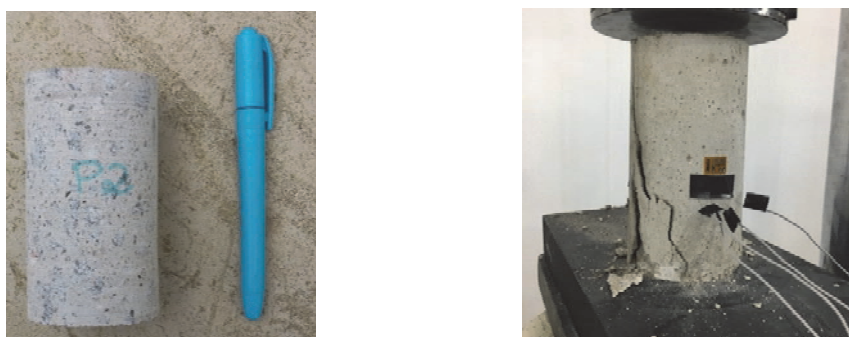
Fig. 2 – Ilustração dos corpos de prova (esquerda) e da instrumentação (direita) o ensaio
